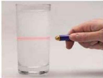
La luz atraviesa el vaso con agua formando una recta. Con este experimento se puede demostrar una propiedad de la luz: **la luz viaja en línea recta.**
