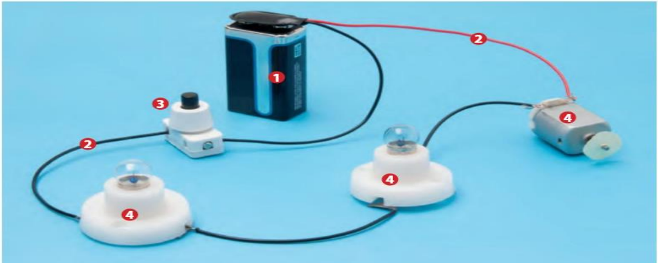
Esquema de los componentes básicos de un circuito eléctrico
